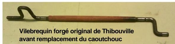
Vilebrequin forgé original de Thibouville avant remplacement du caoutchouc
